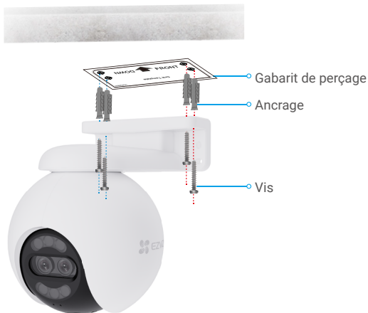
Fig. 1 Montage au plafond
